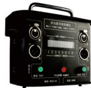
MLC-1多功能测线仪可以快速完成所有扩声系统音频线路的检测，包括线路断路、短路、交叉等测量，测量结果一次性显示。同时，支持本地测量和异地测量，极大地提升系统线路检测效率。
